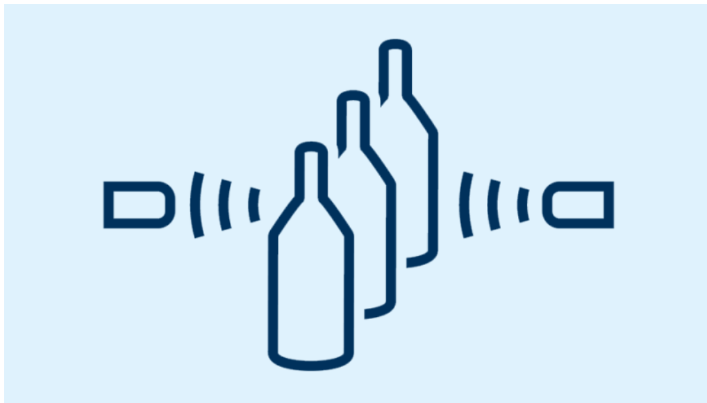
Il principio di funzionamento della barriera a raggi ultrasonici a sbarramento
