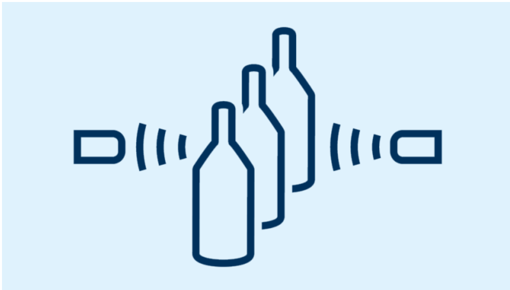
Het werkingsprincipe van zender & ontvanger ultrasoon sensoren
