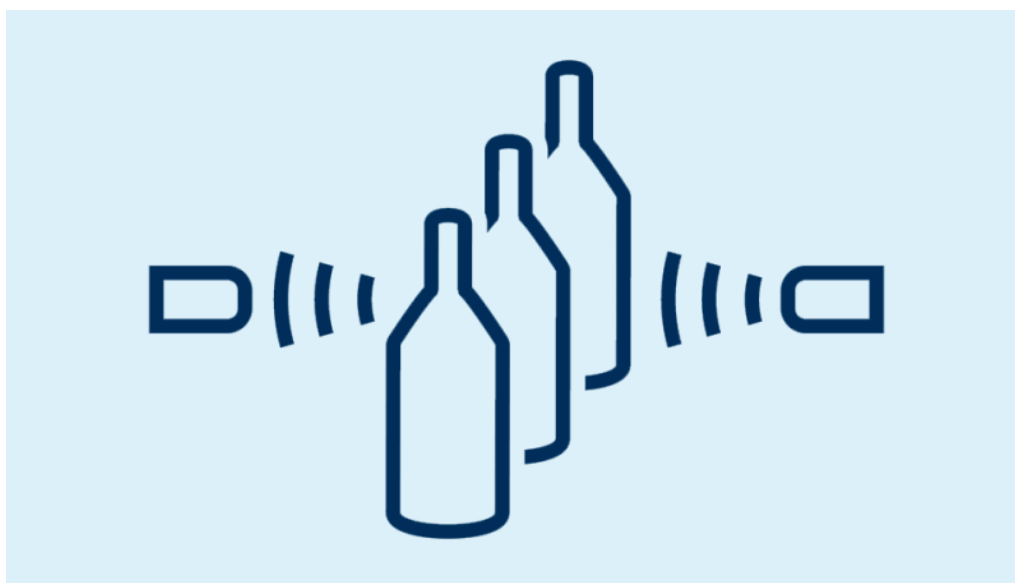
Принцип действия ультразвуковых сквозных барьеров
