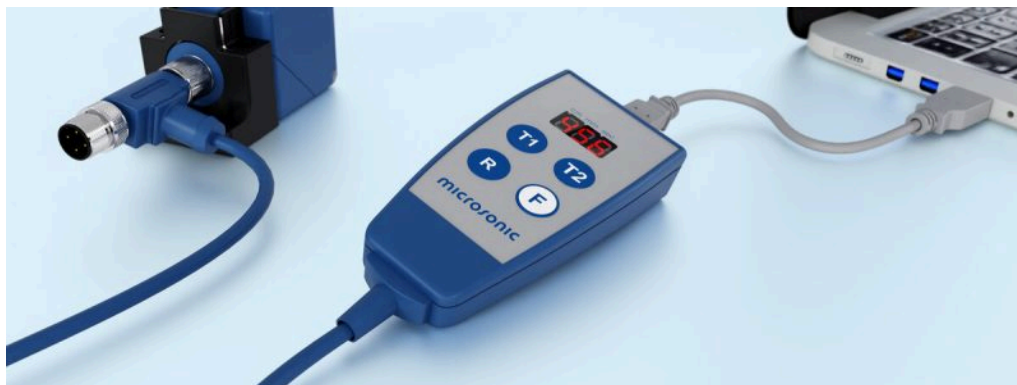
Датчик связывается с ПК через LCA-2 для программирования
