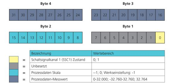
Schaltsignalkanal 1 Zustand:
