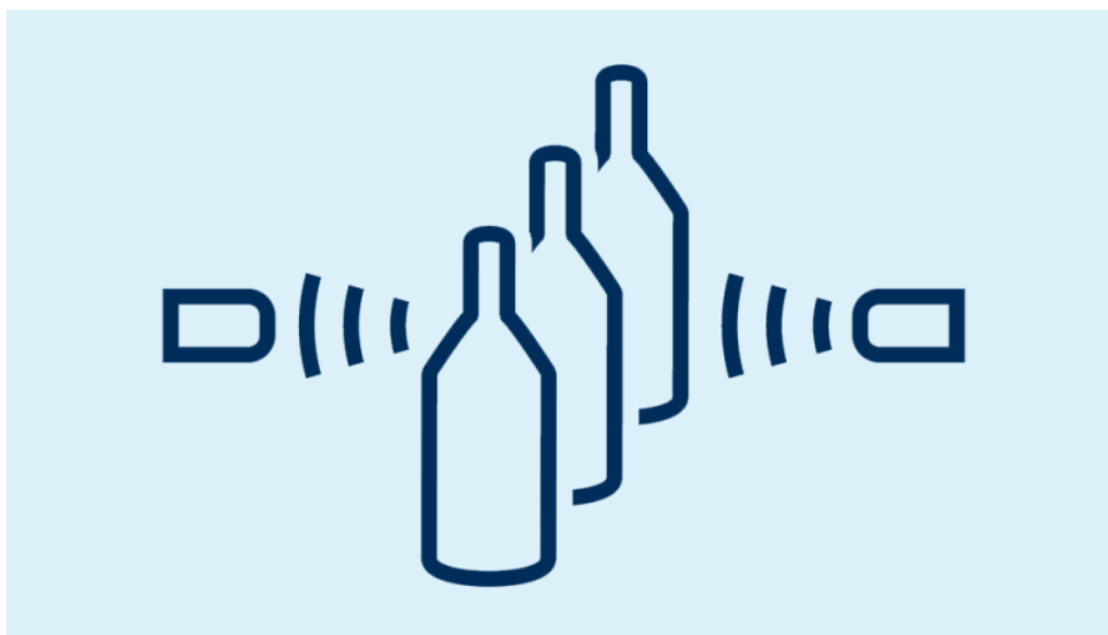
超声波对射传感器的工作原理
