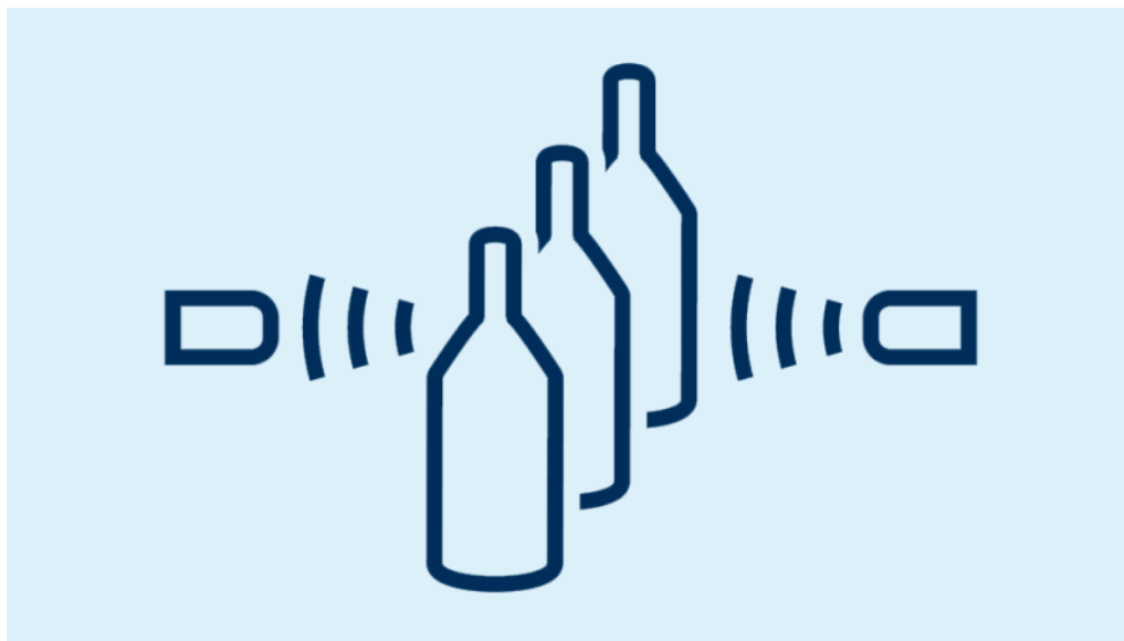
超声波对射传感器的工作原理
