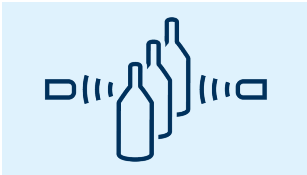
超声波对射传感器的工作原理
