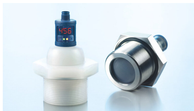
图左: 检测距离为 3.4 m 的 hps+ 340 传感器，带 2" 的氟树脂或者 1.4571 不锈钢螺纹法兰 图右: 特氟隆保护膜用全氟橡胶环形密封圈密封，形成了外壳防护
