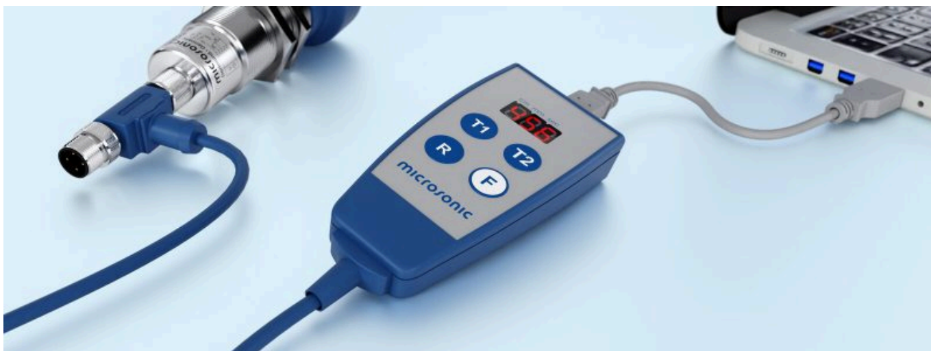
传感器通过LCA-2连接到电脑进行编程
