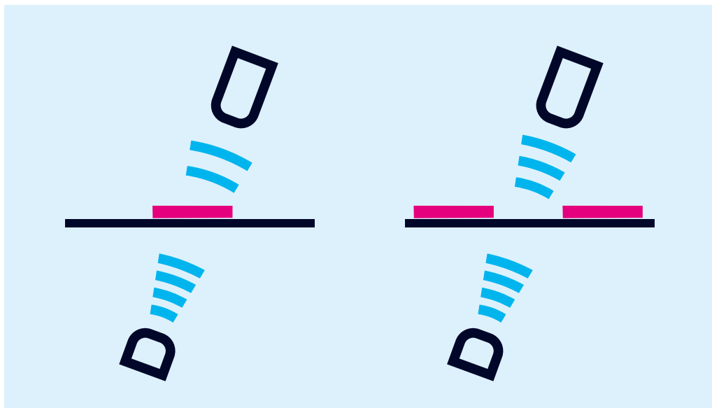
Trägermaterial mit Etikett liefert einen abgeschwächten Signalpegel
