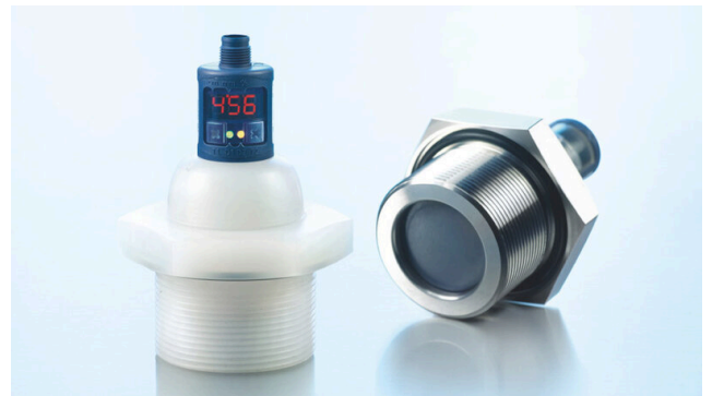
Links: hps+340 Ultraschall-Füllstandssensoren im hochresistenten PVDF-Gehäuse Rechts: PTFE-Schutzfolie mit einem O-Ring aus FFKM gegen das Gehäuse abgedichtet
