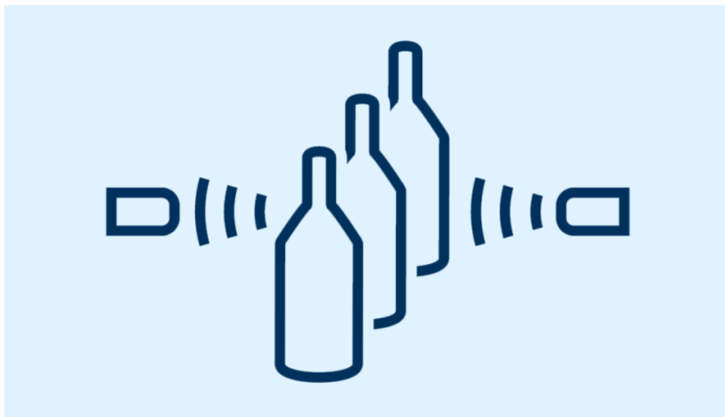
El principio de funcionamiento de las barreras ultrasónicas
