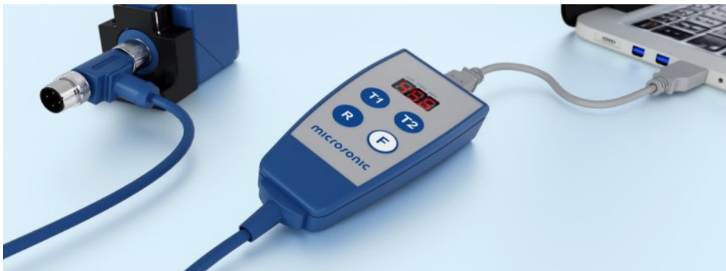
Sensor conectado al ordenador a través de LCA-2 para la programación
