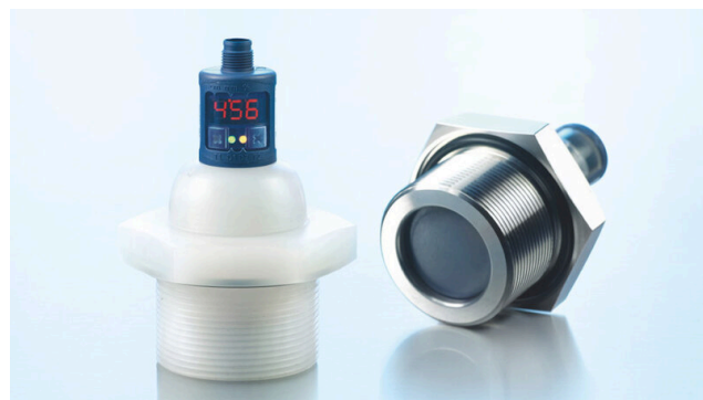
hps+340 en carcasa de PVDF de alta resistencia - Lámina protectora de PTFE aislada de la carcasa con una junta tórica de FFKM
