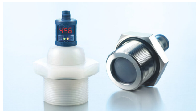
hps+340 dans un boîtier PVDF à haute résistance - Film de protection PTFE avec un joint torique en FFKM avec joint d'étanchéité scellé au boîtier
