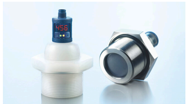
hps+340 dans un boîtier PVDF à haute résistance - Film de protection PTFE avec un joint torique en FFKM avec joint d'étanchéité scellé au boîtier
