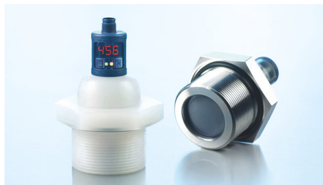
hps+340 in custodia in PVDF ad elevata resistenza - Lamina protettiva in PTFE con o-ring in FFKM a tenuta rispetto alla custodia
