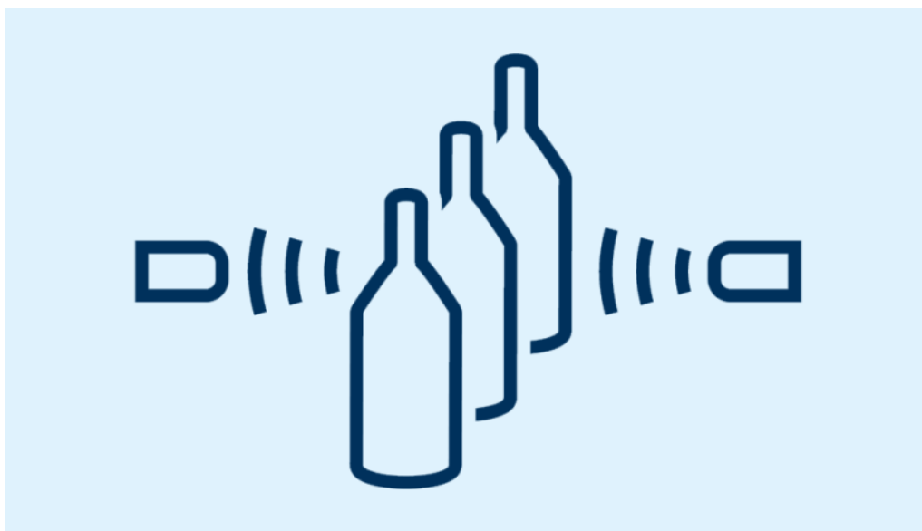
超音波透過型センサの機能原理
