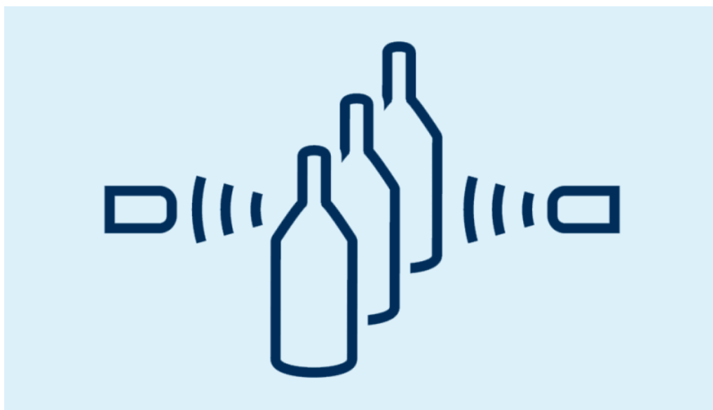
超音波透過型センサの機能原理
