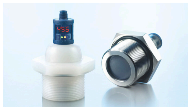
ハウジングに対して密封しているFFKMのOリングの付いた hps+340の高抵抗性PVDFハウジング - PTFE保護フィルム
