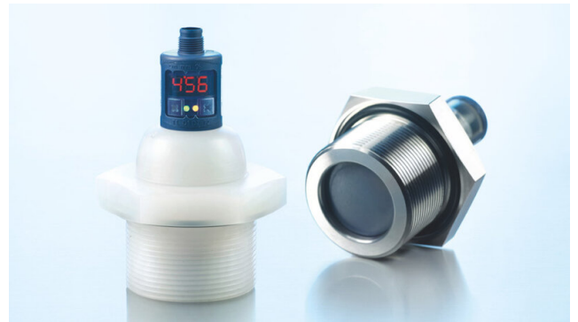
그림의 왼쪽.: 3.4m 동작 범위와 PVDF 또는 임의의 1.4571 스테인리스 스틸에서의 2" 나사산 플랜지를 가진 hps+340 그림의 오른쪽: 하우징에 대하여 FFKM O-ring으로 봉해진 PTFE 보호 필름
