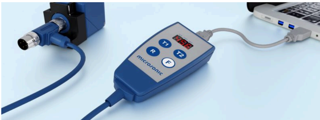
LCA-2를 통해 프로그래밍을 위하여 PC에 연결된 센서.
