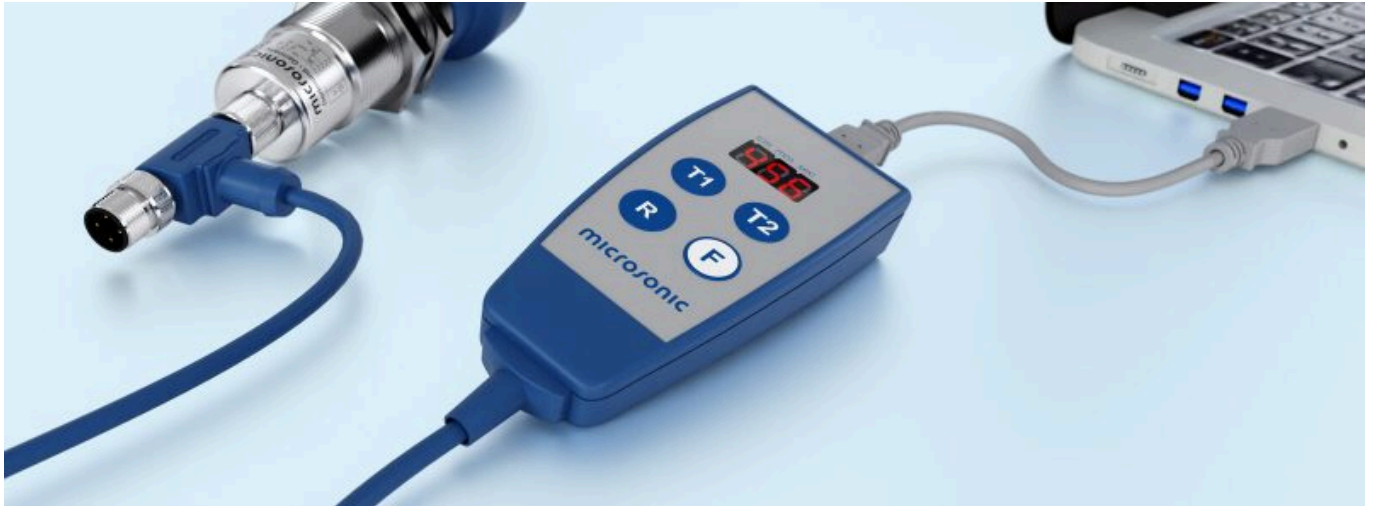
LCA-2를 통해 프로그래밍을 위하여 PC에 연결된 센서.
