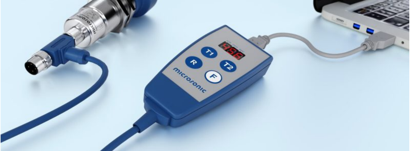
LCA-2를 통해 프로그래밍을 위하여 PC에 연결된 센서.
