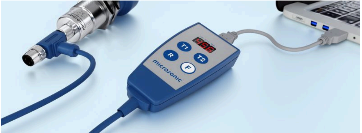
LCA-2를 통해 프로그래밍을 위하여 PC에 연결된 센서.
