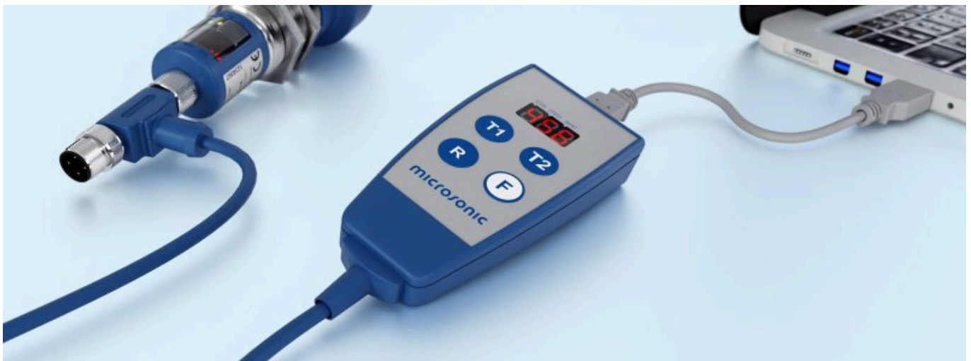
LCA-2를 통해 프로그래밍을 위하여 PC에 연결된 센서.
