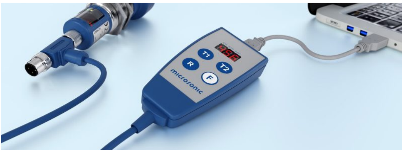
LCA-2를 통해 프로그래밍을 위하여 PC에 연결된 센서.
