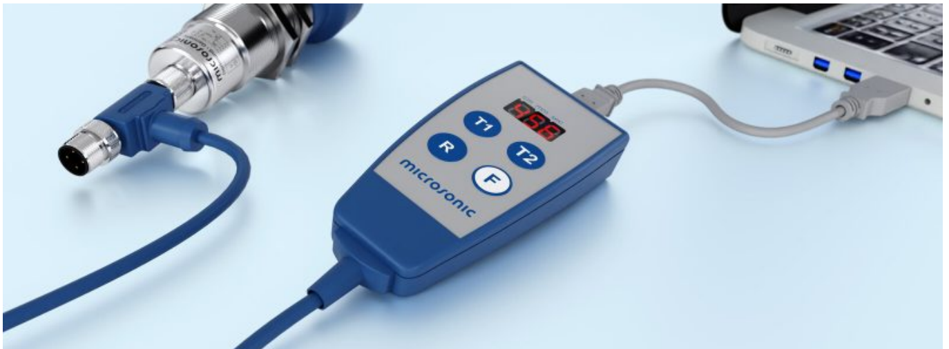
LCA-2를 통해 프로그래밍을 위하여 PC에 연결된 센서.
