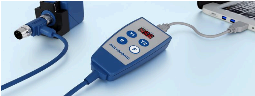
LCA-2를 통해 프로그래밍을 위하여 PC에 연결된 센서.
