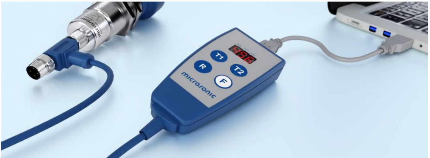
LCA-2를 통해 프로그래밍을 위하여 PC에 연결된 센서.
