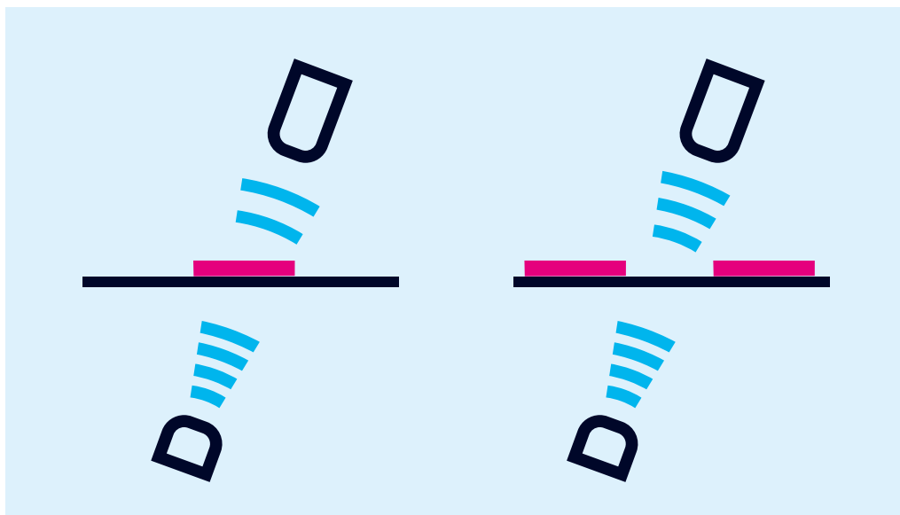
Dragermateriaal met label geeft een afgezwakt signaalniveau
