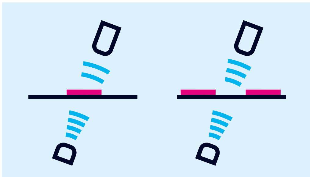
Dragermateriaal met label geeft een afgezwakt signaalniveau
