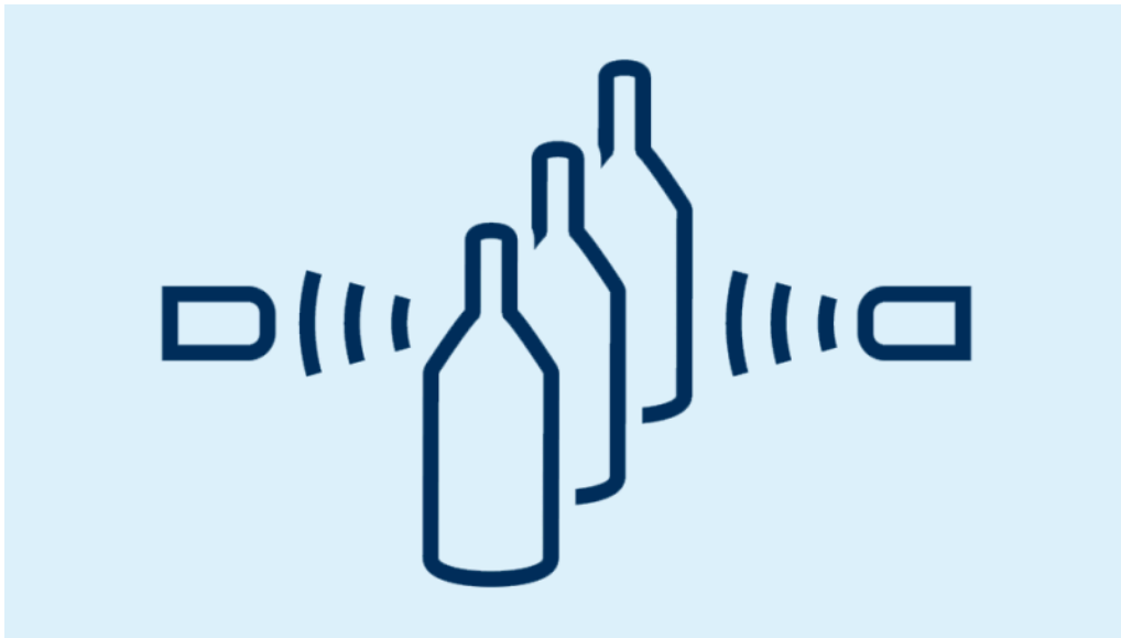
Het werkingsprincipe van zender & ontvanger ultrasoon sensoren
