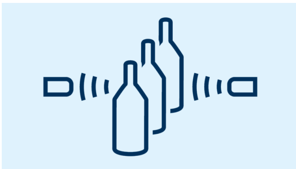
Принцип действия ультразвуковых сквозных барьеров
