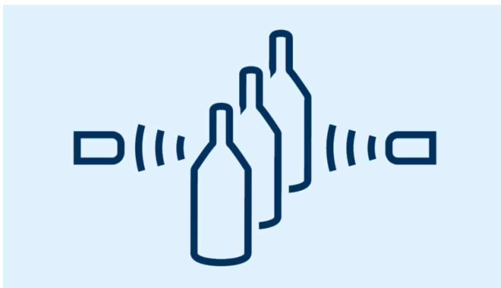
Принцип действия ультразвуковых сквозных барьеров
