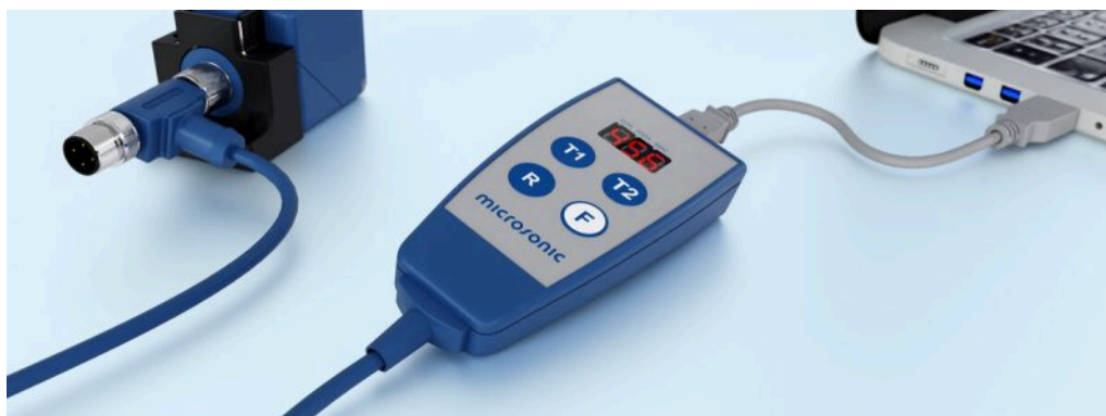
Датчик связывается с ПК через LCA-2 для программирования
